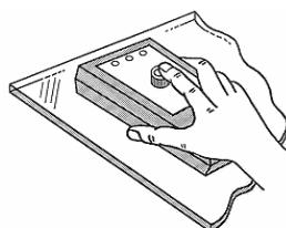
Пожалуйста, обратите внимание на то, чтобы прибор был удален минимум 10 см от рамы. Закройте противоположную сторону проверяемого стекла или рукой, или каким-то предметом, так как из-за этого результат может быть искажен.
